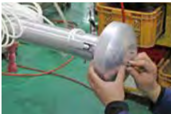
冠頭部の組み立て
